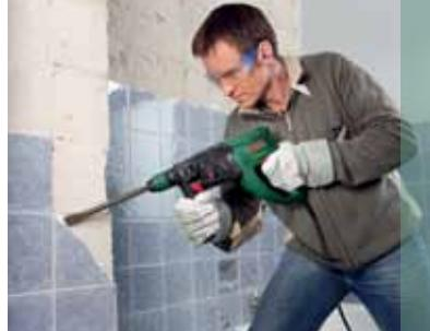
Takto se z kladiva Bosch stane sekací kladivo: Jednoduše otočíte na vypnutí otáčení, nasadíte sekáč a do toho. Vario-Lock pro 36 poloh sekáče: Plochý sekáč tak lze vždy optimálně přizpůsobit příslušné pracovní situaci.
