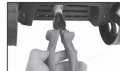
Vytiahnutie filtra z otvoru prívodu vody, Obr.14
