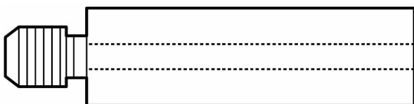
Obrázek H – Koaxiální kartuše ( typ „v sobě“ ) – tvrdidlo a pryskyřice jsou v soustředných zásobnících
