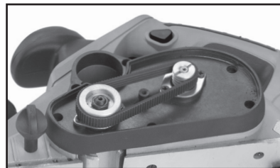
Obr. 11, hnací remeň na modele hobľníka EP 850
