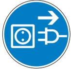
**Vor jeglichen Arbeiten/Tätigkeiten an der Maschine ist diese von der Spannungsversorgung zu trennen! Verwenden Sie das Netzkabel nie zum Transport oder zur Manipulation der Maschine!**
