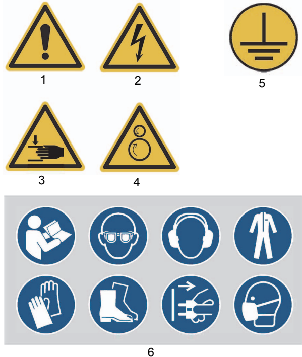
Obr. 1: Výstražné štítky 1 Varování před nebezpečím | 2 Varování před nebezpečným elektrickým napětím | 3 Nebezpečí skřípnutí horních končetin | 4 Varování před otáčejícími se díly | 5 Symbol uzemnění | 6 Nepoužívejte ochranné rukavice
