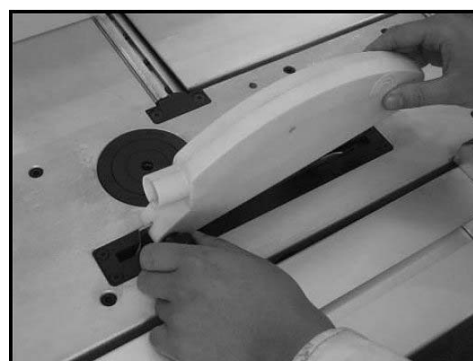
Obr. 18: Montáž ochranného krytu pilového kotouče
