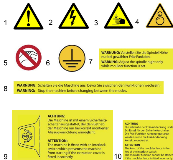
Obr. 1: Výstražné štítky - 1 Obecné nebezpečí | 2 Varování před nebezpečným elektrickým napětím | 3 Nebezpečí skřípnutí horních končetin | 4 Varování před otáčejícími se díly, nebezpečí skřípnutí | 5 Nebezpečná oblast | 6 Uzemnění | 7, 8, 9, 10 Bezpečnostní pokyny
