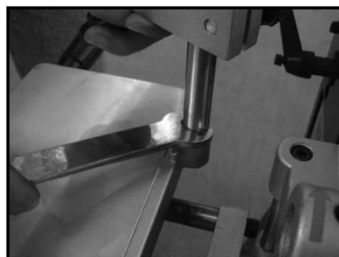
Obr. 12: Montáž upínacího zařízení obrobku
