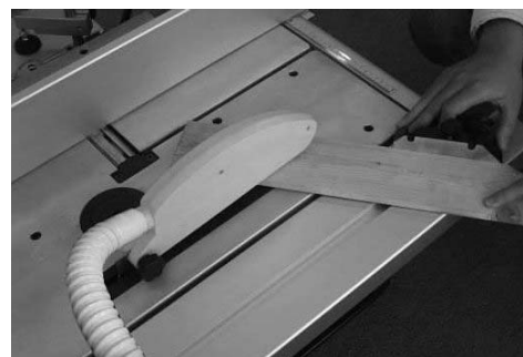
Obr. 23: Úhlový řez pomocí úhlového dorazu
