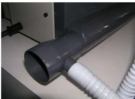
Obr. 21: Montáž odsávací hadice na odsávací trubku
