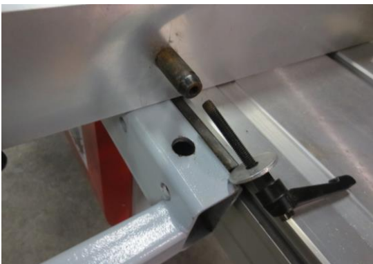
Nasadte úhlové pravítko do otvoru podpěrného rámu
