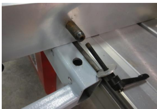
Nasadte úhlové pravítko do otvoru podpěrného rámu
