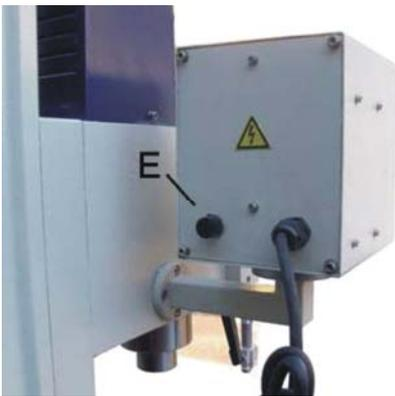
Maschinensicherung (E) mit 10A ist an der Rückseite der Bedienkonsole positioniert. Drehen Sie den Knopf gegen den UZS um diesen zu öffnen und die Sicherung zu wechseln. UZS um wieder anzuziehen.
