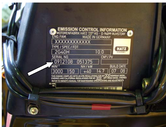
Obr.5 Výrobní číslo motoru Hatz
