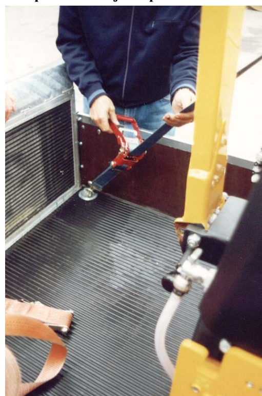
Obr. Upevnění stroje na přívěsu
