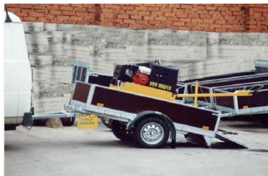
Obr. Upevnění stroje na přívěsu
