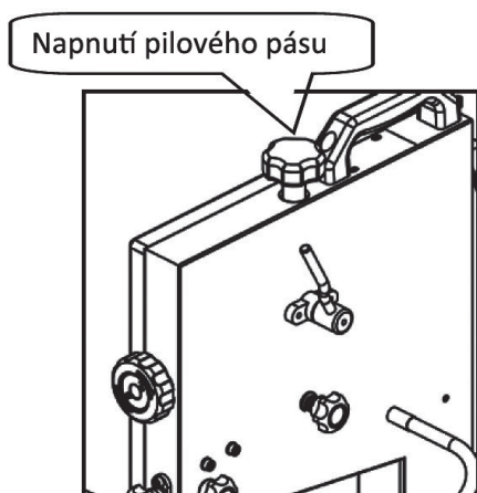
Obr. 22: Napnutí pilového pásu
