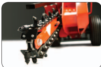
Odpružené kladívkové hroty z kvalitní ocele.
