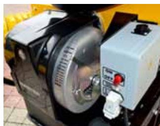
Ovládací panel obsahuje: vypínač ON/Vypnutý se světelným ukazatelem, tlačítko reset, zásuvku pro dálkově řízený termostat: analogový nebo digitální
