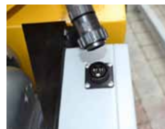
Motor je k elektronickému panelu připojen zacvakávacím konektorem, což umožňuje snadnou údržbu
