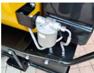
Palivový filtr se nachází nanější straně. Předehřev paliva se nachází uvnitř spalovací hlavy.
