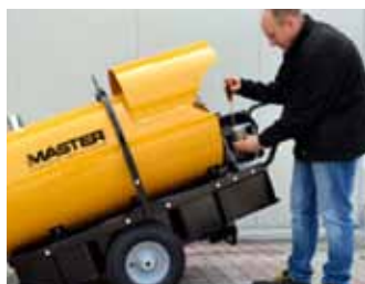
Lze naklonit pro snadný přístup k hořáku a elektronickému ovládacímu panelu
