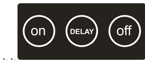
**ON:** Při zaznamenání deště se robot vrátí do dobíjecí stanice. Po dokončení dobíjecího cyklu robot obnoví automatický provozní režim, jestliže čidlo nezaznamená dešť.
