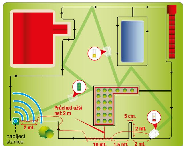
V případě úzkých prostorů nebo šipky pro rychlý návrat do dobíjecí stanice je nutné umístit hraniční kabel ve zvláštním tvaru zvaném "Přivolání podél drát".
