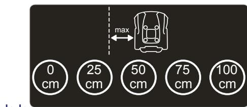
“0 cm”. Doporučené nastavení pro složité zahrady s mnohými překážkami v blízkosti obvodového kabelu a s úzkými průchozími prostory. Robot umístí kola vedle obvodového kabelu pro návrat do dobíjecí stanice.
