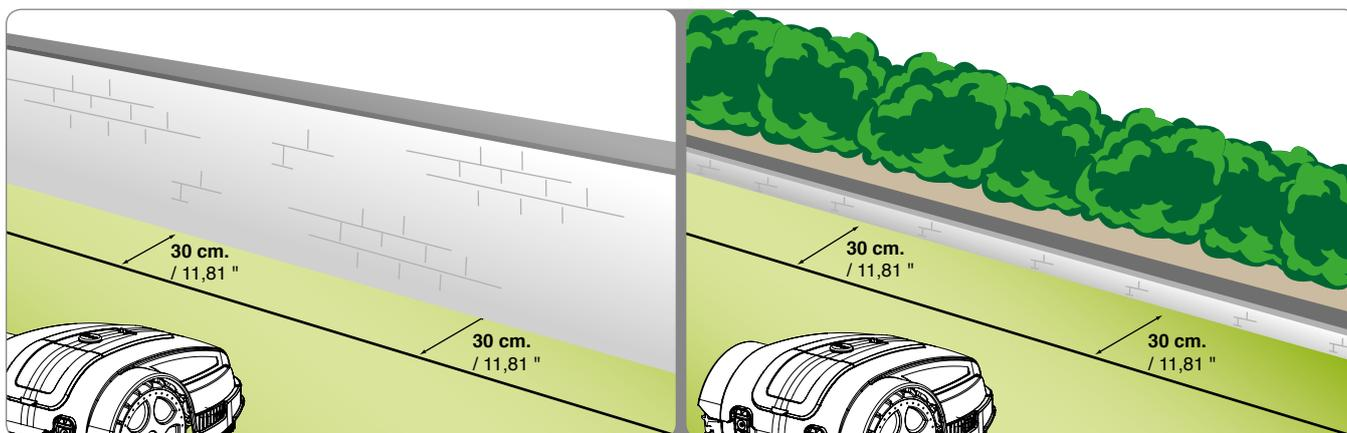
Když se uvnitř nebo zvenčí pracovní plochy nachází záhon, živý plot, rostlina s přečnivajícími kořeny, malý příklop (2-3 cm) nebo malý obrubník (2-3 cm), položte obvodový drát do vzdálenosti nejméně 25 cm (9,84 "), aby se zabránilo poškození robotické sekačky nebo přítomných překážek. Sekání případné trávy na ploše, na které jste se rozhodli neumožnit činnost robotické sekačky, bude možné provést s použitím ořezávače okrajů trávníku nebo křovinořezu.
