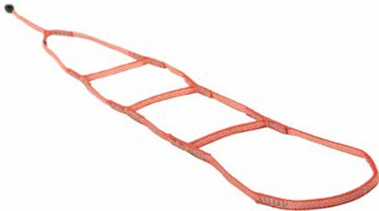
C2151BY00 JACOB DYNEEMA Všestranný ultralehký lezecký žebřík. ■ určený pro technické lezení a práci ve výškách ■ každé oko může být zatíženo ve všech směrech ■ skvěle využitelný i pro záchranu ■ nosnost každého oka - 22 kN ■ využitelný také jako nastavitelná smyčka pro kotvení
