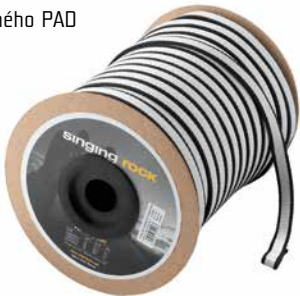
C0037BB12 - black C0037RR12 - red DUTÝ POPRUH ■ šíře popruhu 20 mm ■ vyrobeno z nízkoprůtažného PAD ■ maximální délka: 120 m ■ hmotnost: 38,2 g/m (černá), 39,4 g/m (červená) ■ pevnost: 16 kN (černá), 17 kN (červená)
